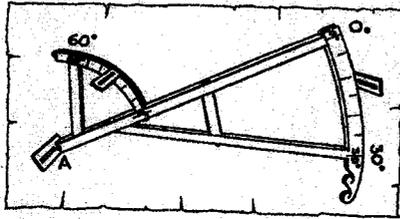
Das Gerät bestand aus einer Leiste, auf der zwei Kreisbögen mit dem Mittelpunkt A befestigt waren. Der obere Kreisbogen trug eine Einteilung von  $0^\circ$  bis  $60^\circ$ , der untere war von  $0^\circ$  bis  $30^\circ$  unterteilt. Auf beiden Bogenstücken war jeweils ein verschiebbarer Spalt angebracht. Im Zentrum A der beiden Kreisbögen befand sich ein weiterer Spalt.
